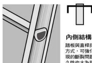
內側結構接合構造
