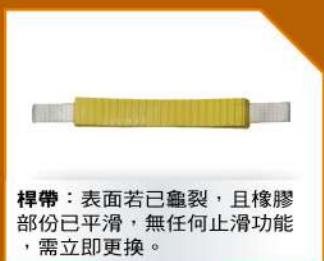
桿帶：表面若已龜裂，且橡膠部份已平滑，無任何止滑功能，需立即更換。
